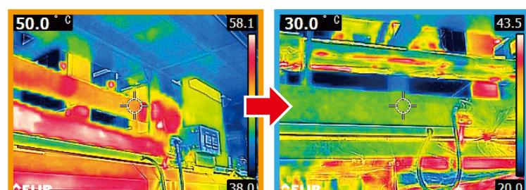
検証時 热を見える化して熱漏れ・輻射熱を確認
